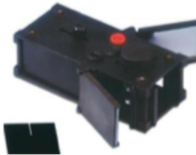
Prendre la lanterne du côté des miroirs et laisser ceux-ci fermés. Placer le filtre jaune, puis juste devant le filtre cyan de façon à ce qu'ils soient superposés (l'un devant l'autre).
