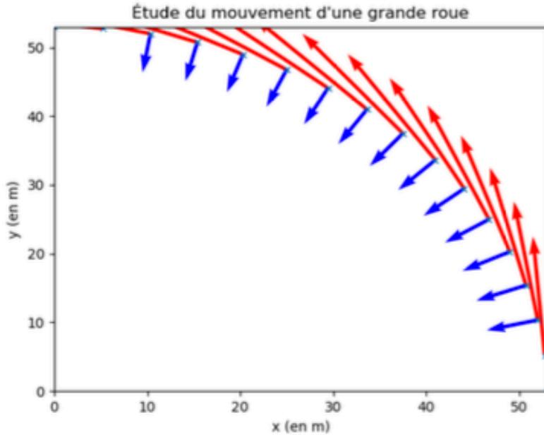
Le centre du repère est au centre de la grande roue. On étudie le mouvement du centre de masse d'une cabine. Le mouvement obtenu est un mouvement circulaire (un quart de cercle ici) de rayon  $r = 53$  m. Le diamètre de la grande roue est donc de  $D = 2 \times 53 = 106$  m.
