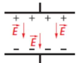
**Exercice 36 :** Un condensateur plan est constitué de deux armatures planes et parallèles séparées par un milieu isolant comme l'air.
