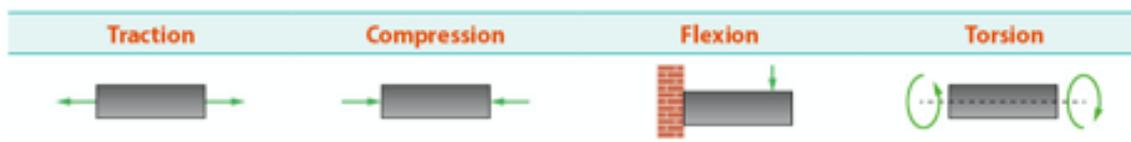
▲ Exemples de contraintes mécaniques sur un matériau
