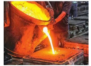
Métal en fusion dans une fonderie
